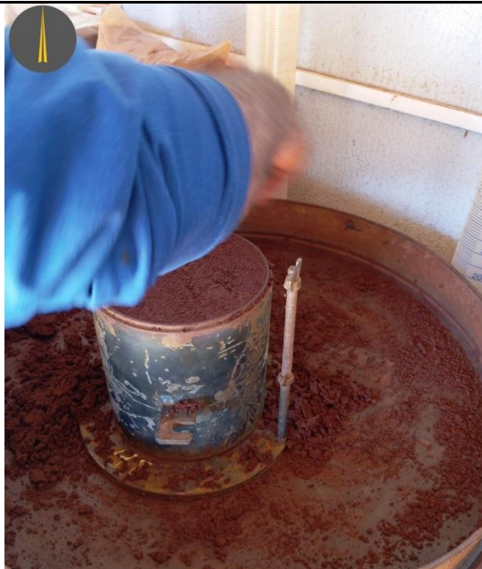
Imagem 05: Ensaio de compactação
